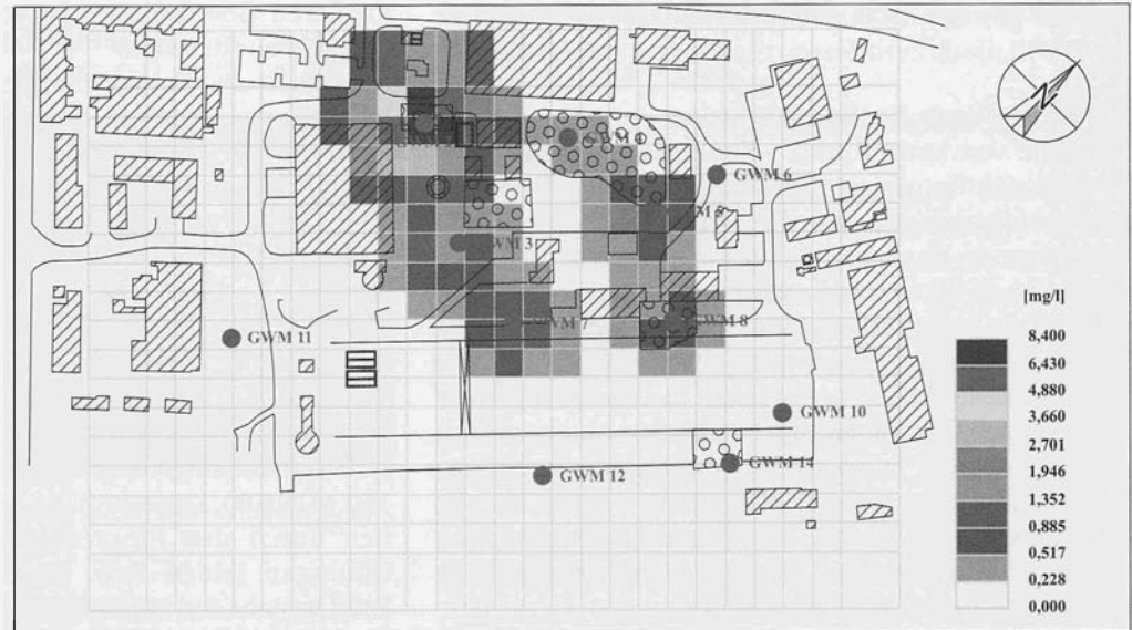
Abbildung 3: Grundwasserkontamination interpoliert aus Messwerten (Phenol)
